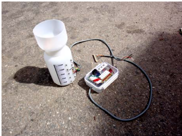
設置する雨量計セット
