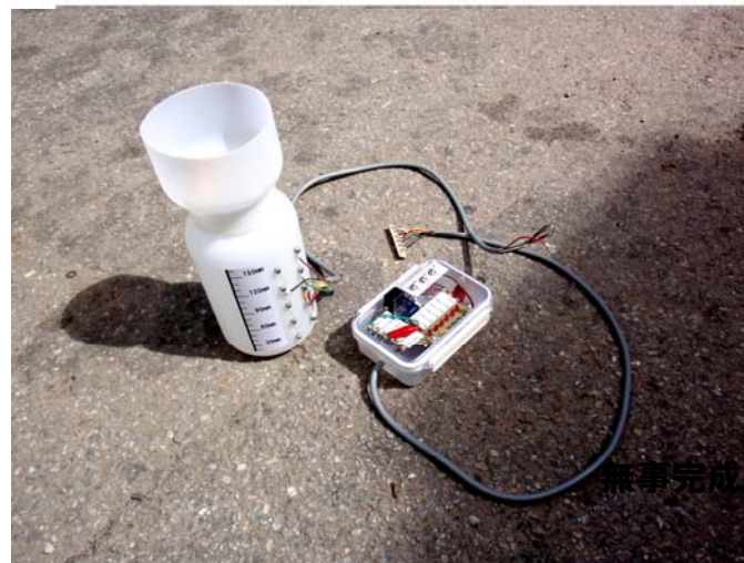
完成した雨量監視警報装置
